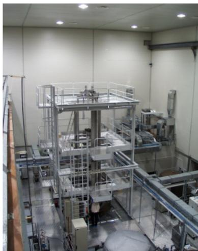
Système de suspension des miroirs : chaîne de 7 pendules (isolation sismique horizontale) dont chaque élément est constitué de lames triangulaires oscillantes (isolation sismique verticale)
