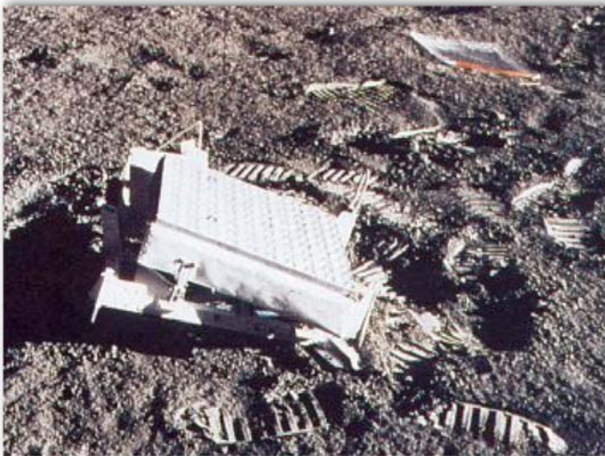
Apollo 14 retroreflector array
